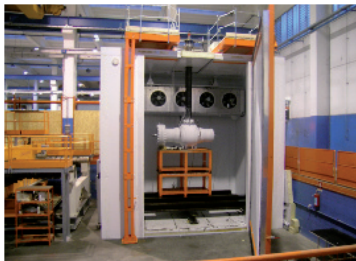
FIG|04 Valvola criogenica al collaudo nella nostra cella climatica in grado di testare valvole fino a 48" classe 600 completi di attuatore, a una temperatura da -50 °C a +80 °C (in particolare questa valvola era per il progetto sakhalin fase 2).
