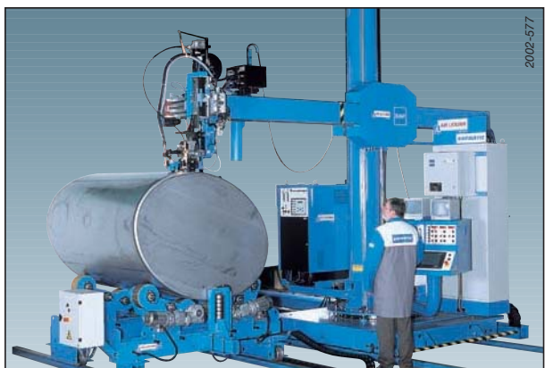
Saldatura di corpi ellittici con manipolatore e posizionatore a rulli o tavola rotante
