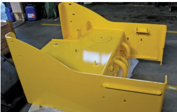
FIG|03 Serbatoio idraulico macchine movimento terra.
