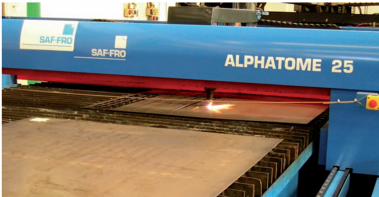
FIG 01 | La macchina durante il taglio lamiera.
