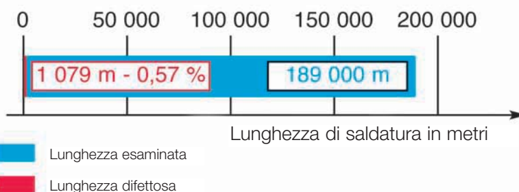
Esempio dei risultati ottenuti in Spray-Modal ® nella costruzione navale in alluminio
