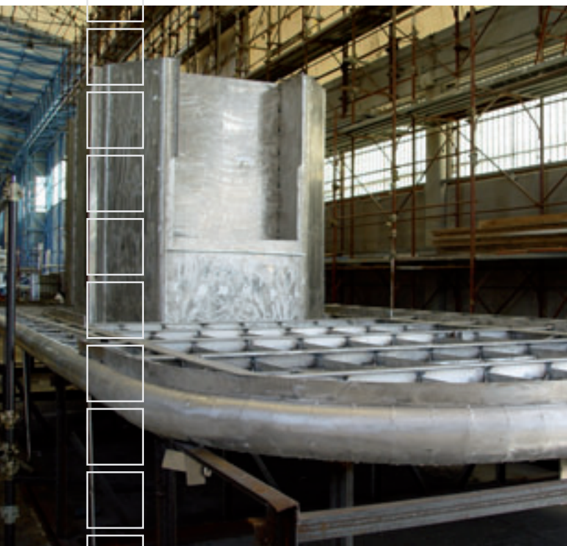
Il materiale il lega leggera 5083 H321 utilizzato per le imbarcazioni di Rossinavi.
