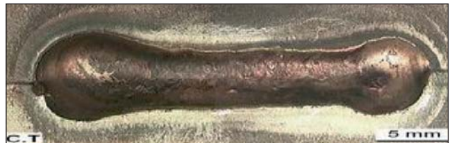
Figura 9 - Saldobrasatura su acciaio zincato di spessore 0,8 mm.
