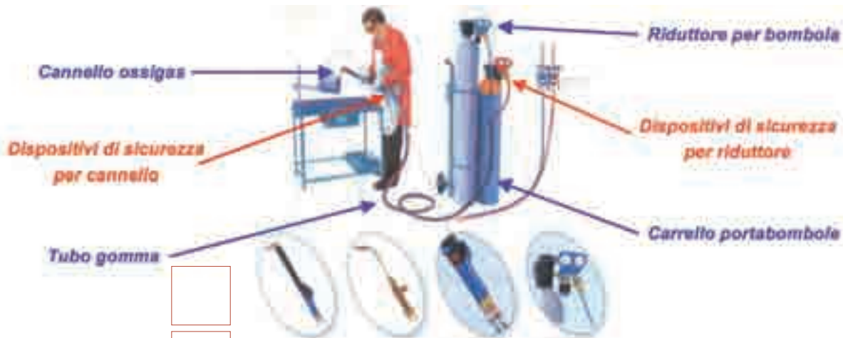
La composizione di una postazione mobile ossigas (postazione su carrello o fissa).
