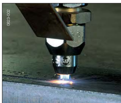
L'ossitaglio è un procedimento termico che consente il taglio degli acciai non legati e bassolegati.
