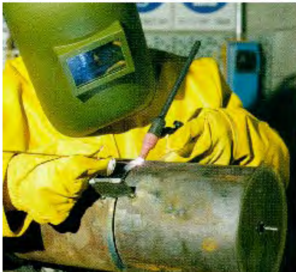
Figura 12- - Applicazioni manuale ed automatica del processo TIG.
