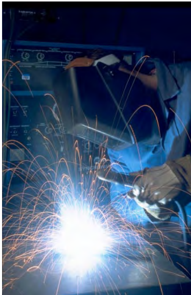
Figura 1- Saldatura manuale ad arco con elettrodi rivestiti
