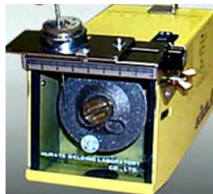
Figura 21 - Dispositivo per la raccolta delle polveri durante il rifacimento della punta all'elettrodo
