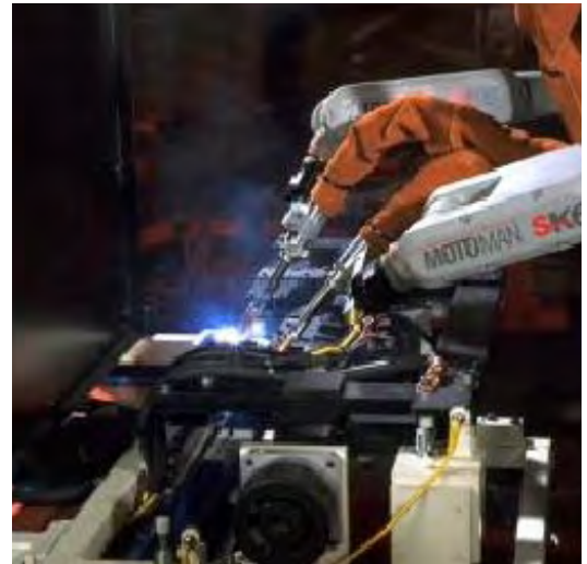
Figura 10 - Applicazioni robotizzate della saldatura GMAW.
