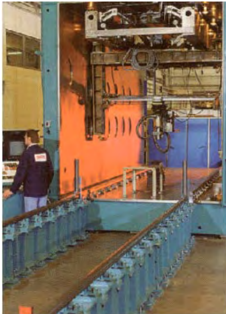
Figura 13- - Camera per la saldatura a fascio elettronico (sotto vuoto)
