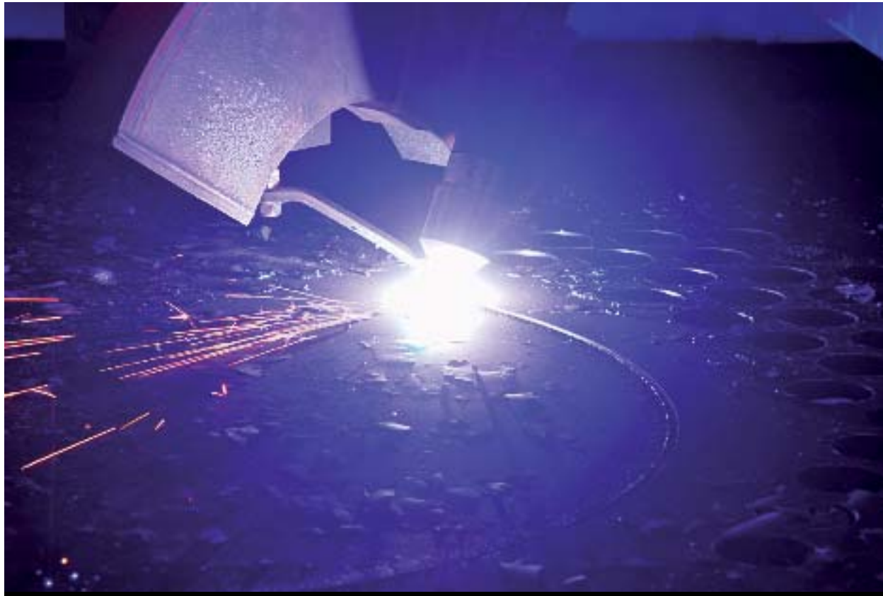
FIG 02 La maggior parte delle cianfrinature eseguite in Ferroli con la nuova Alphotome sono a 30 gradi, il valore ideale per gli spessori di lamiera più utilizzati.
